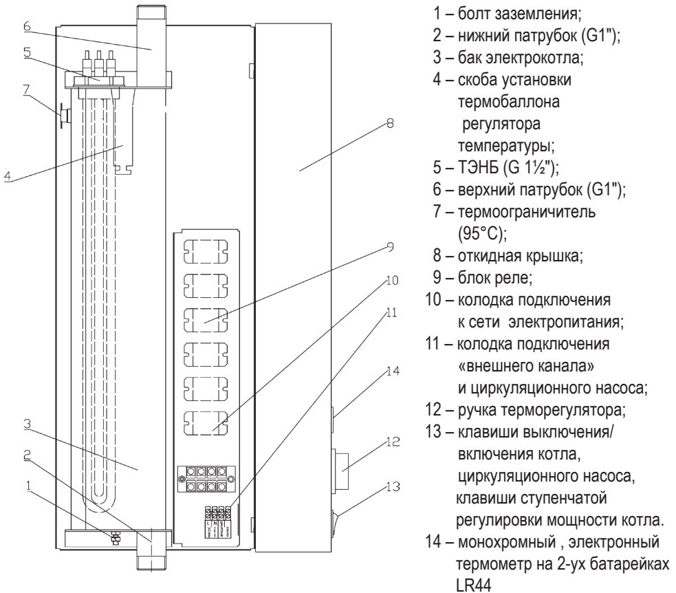
Рис. 1. Устройство электрокотла (крышка открыта).
